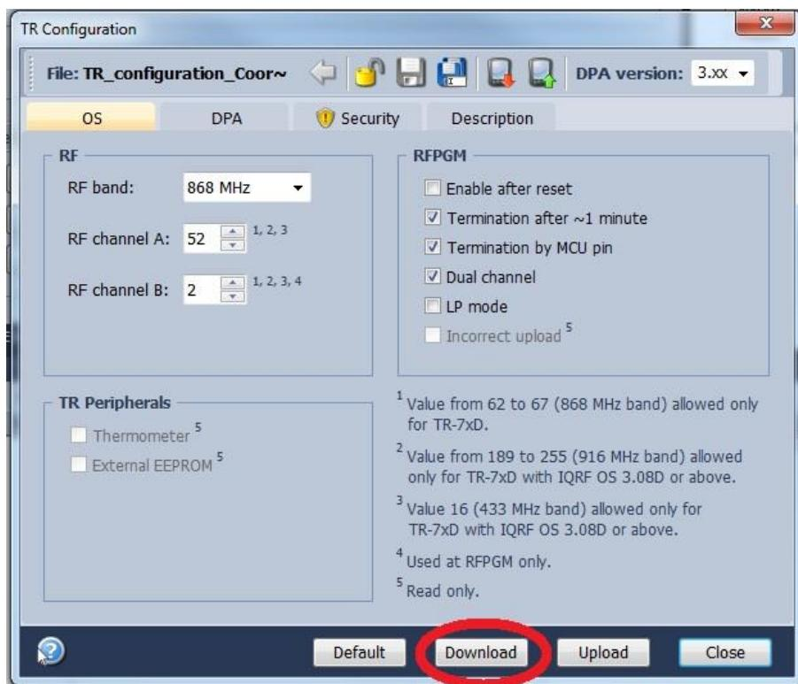
Nyní provedeme potřebné změny a následně vytvořenou konfiguraci nahrajeme do modulu pomocí tlačítka Upload.
